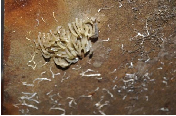
Рисунок 5.4 – Обрастание поверхности образцов нержавеющей сталей морскими организмами при испытании образцов в Черном море
