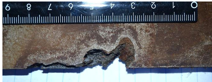
Рисунок 5.5 – Щелевая коррозия на кромках образцов нержавеющей сталей (в местах соединения образцов с кассетой)
