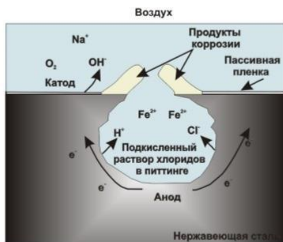
Рисунок 1.2 – Схематическое изображение развития питтинговой коррозии [4]
