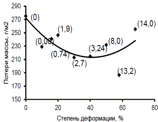
Рисунок 1.7 – Влияние степени деформации при температуре 20 °C образцов стали 12X18H10T на потери массы при испытаниях в 10%-ном растворе FeCl 3 в течение 559 ч (в скобках приведены значения объемной доли \alpha' -мартенсита, %) [74]
