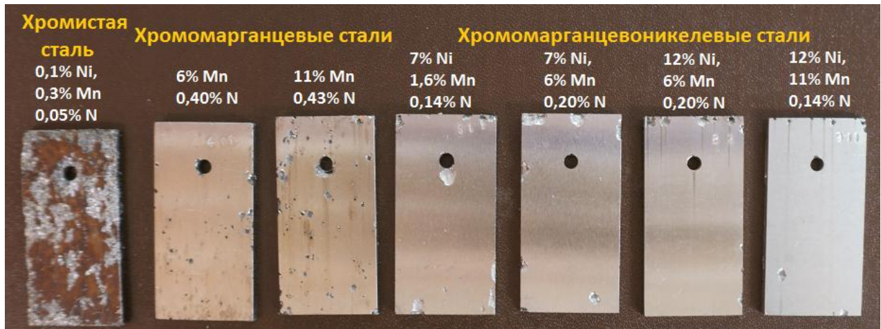
Рисунок 3.3 – Внешний вид образцов сталей базового состава 04X20M2ФБ с переменным содержанием никеля, марганца и азота после испытаний в 10% FeCl 3 ·6H 2 O при 40°C в течение 24 часов
